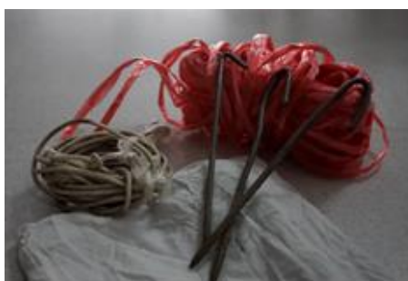
รูปที่ 51 แสดงลักษณะสมอบก เชือก (1) และถุงผ้าดิบ (2)
