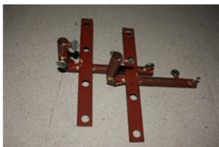
รูปที่ 89 แสดงลักษณะของอุปกรณ์ยึดคานบน เสาและคานจิงเส้นเอ็น
