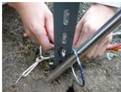
รูปที่ 65 แสดงการติดตั้งห่วงวงกลมใหญ่ที่ยึดอยู่กับหนังยางเข้าไปในเสาที่ตอกทำมุม 45 องศา
