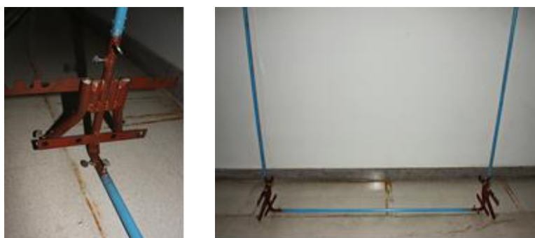
รูปที่ 93 แสดงการประกอบคานด้านล่างเข้ากับโครงขาตั้ง
