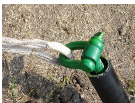
รูปที่ 77 แสดงการนำเชือกตาข่ายมามัดติดกับห่วงของลูกตุ้มเหล็ก (1) และการสาวตาข่าย (2)
