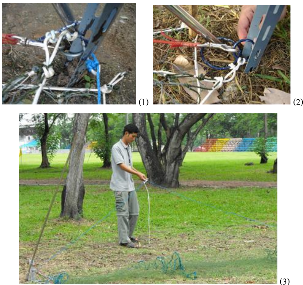
รูปที่ 66 แสดงการนำสติกมาประกอบกับห่วงวงกลมเล็กและแผ่นเหล็ก (1,2) และโยงเชือกไว้กับสติก (3)
