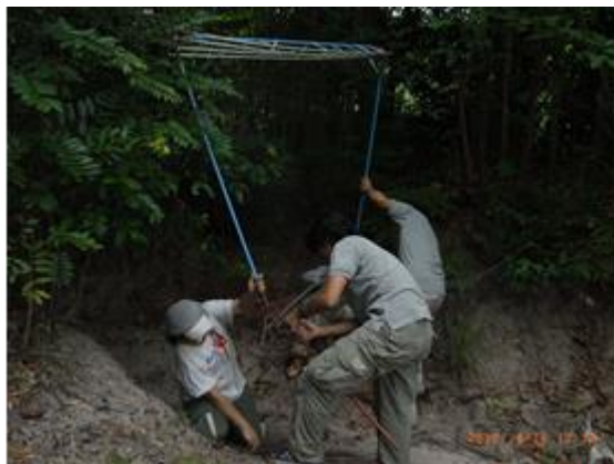
รูปที่ 96 แสดงการประกอบขาตั้งปรับระดับความสูงเข้ากับโครงขาตั้ง
