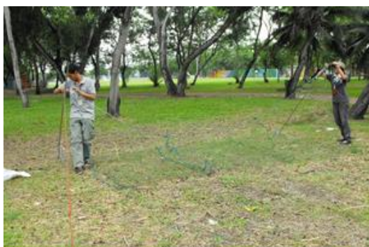
รูปที่ 65 แสดงการติดตั้งห่วงวงกลมใหญ่ที่ยึดอยู่กับหนังยางเข้าไปในเสาที่ตอกทำมุม 45 องศา
