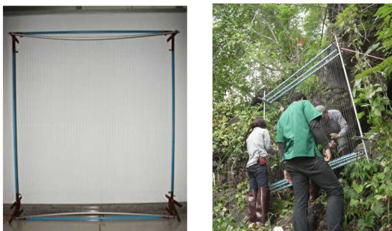
รูปที่ 95 แสดงการประกอบคานชิงเส้นเอ็นเข้ากับอุปกรณ์ยึดคานด้านบนและโครงขาตั้ง
